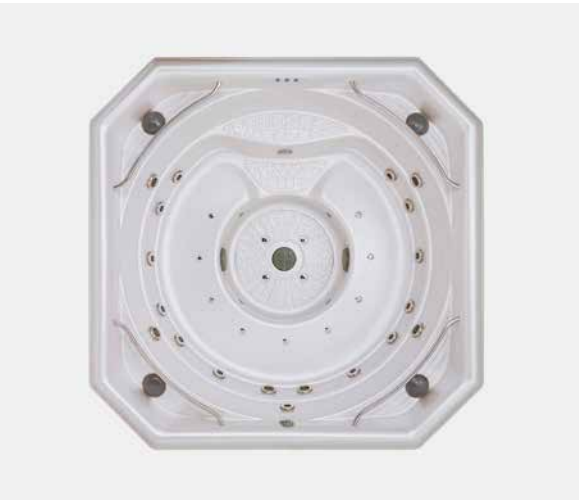
Rondo Mått: 200 × 200 × 82,5 cm, Volym: 980 liter, Vikt: 270 kg Vattenjets: 27 st, Luftjets: 9 st Vattenpumpar: 1 st 1,5 kW 3 HP, Värmare: 9 kW
